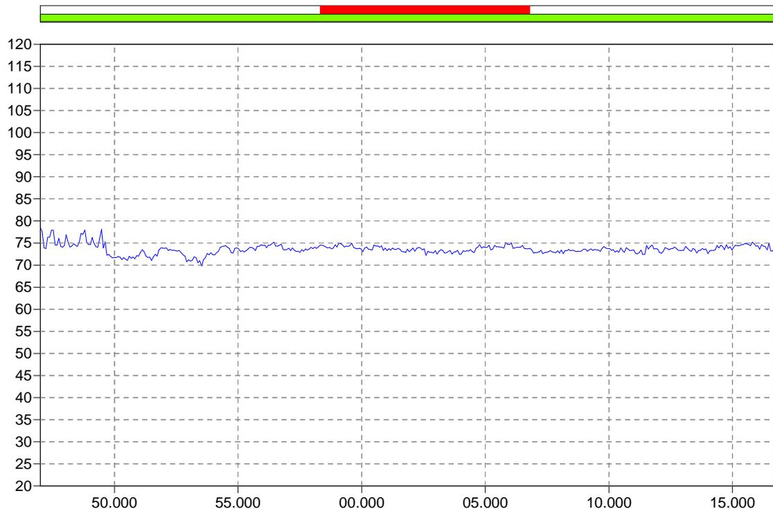
Abbildung 7: M1 Pegelzeitverlauf, untersuchter Zeitraum rot markiert.
