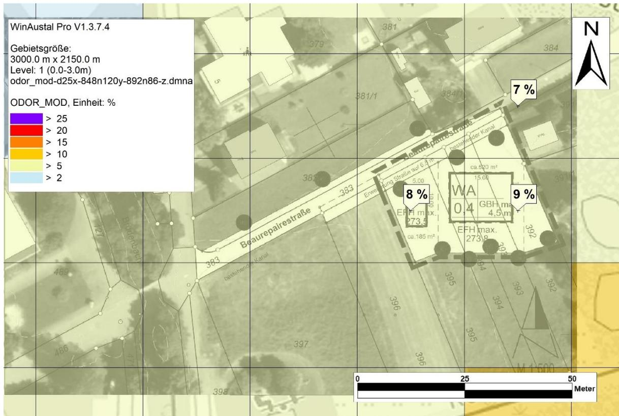
**Abb. 7.1:** Berechnete Gesamtbelastung für Geruch als Geruchsstundenhäufigkeit in Prozent der Jahresstunden
