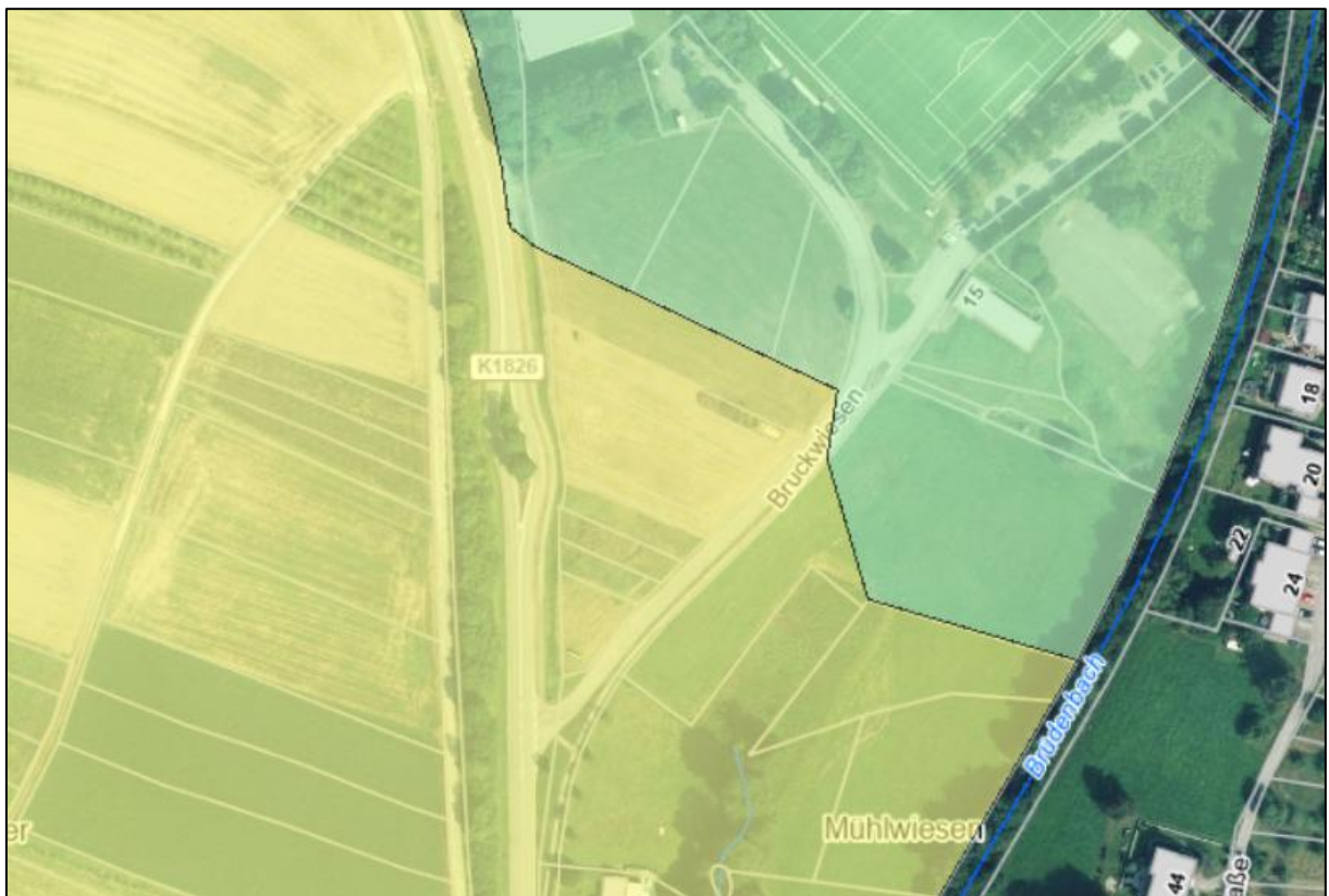
Abb. 5: Darstellung der Wasserschutzgebietszonen (Zone I und II bzw. IIA = gelb, Zone III und IIIA = grün); Kartengrundlage: Kartengrundlage: Räumliches Informations- und Planungssystem (RIPS) der LUBW, Amtliche Geobasisdaten © LGL, www.lgl-bw.de, Az.: 2851.9-1/19
