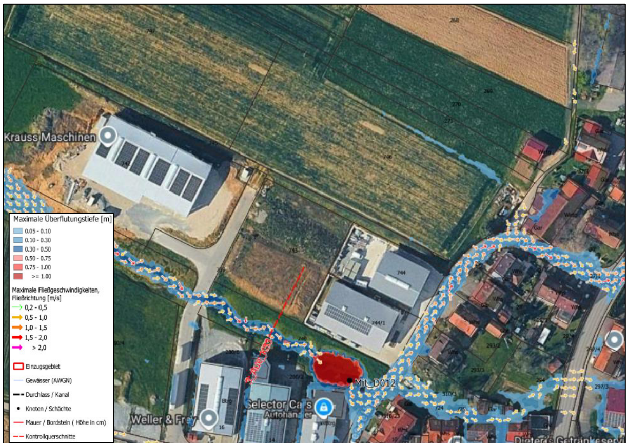
Abb. 5: Ausschnitt der Starkregengefahrenkarte für das Plangebiet; Kartengrundlage: Klinger und Partner Ingenieurbüro für Bauwesen und Umwelttechnik GmbH, Kommunales Starkregenrisikomanagement, ZV Hochwasserschutz Weissacher Tal
